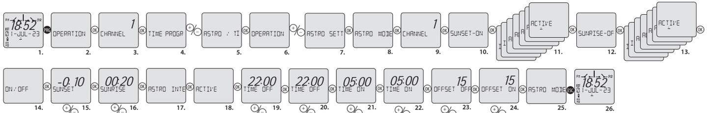
Einstellung des 1. Kanals zur Umschaltung von Sonnenuntergang auf Sonnenaufgang mit einer Abweichung (Offset) für Sonnenuntergang um -10 Min. und für Sonnenaufgang um +20 Min. mit Nachtpause mittels der Zeitprogramme von 22:00 bis 5:00 Uhr jeden MONTAG - FREITAG. **Diese Konfiguration berücksichtigt die Sonnenaufgangs- und Sonnenuntergangszeiten nicht**, was dazu führen kann, dass der Kontakt auch dann schließt, wenn dies nicht mehr wünschenswert ist (z. B. nach dem Sonnenaufgang).
