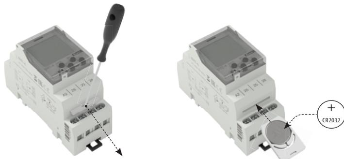
Sie können die Batterie benutzerfreundlich, ohne Demontage des Geräts, bei an- oder ausgeschalteter Netzspannung austauschen.
