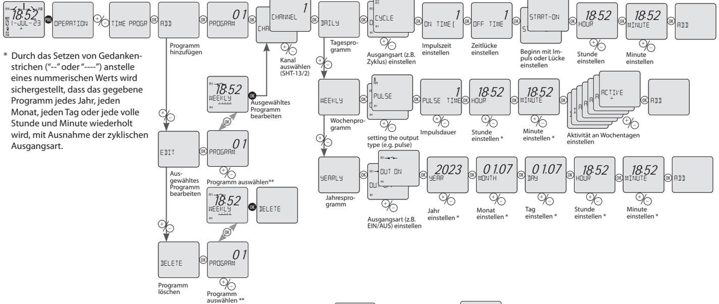
\* Durch das Setzen von Gedankenstrichen ("-" oder "--") anstelle eines numerischen Werts wird sichergestellt, dass das gegebene Programm jedes Jahr, jeden Monat, jeden Tag oder jede volle Stunde und Minute wiederholt wird, mit Ausnahme der zyklischen Ausgangsart.
