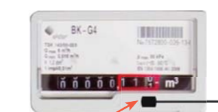
Doğalgaz sayacına için manyetik sensör
